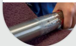
**Schleifkorn, eingebettet in eine dreidimensionale Nylonbahn.** Das Vliesmaterial passt sich der Oberfläche perfekt an und erzielt ein leichtes Finish ohne die Werkstückgeometrie wesentlich zu verändern. Leichtes Reinigen, Anschleifen und Feinschleifen.
