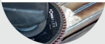
**Materialabtrag, Schweißnahtbearbeitung, Mattieren oder Strukturieren** – verschiedenste Schleifmaterialien passend für jede Anwendung. Eine Auswahl von Premium-Schleifkörnungen auf unterschiedlichen Trägermaterialien. Verschiedene hochwertige Schleifkörner auf einer Baumwoll-, Polyester-, oder Gemischunterlage.
