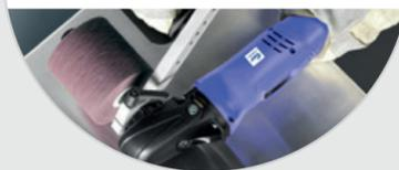
**1 Maschine – 5 Lösungen.** Die Standardmaschine kann Scheiben bis zu 230 mm aufnehmen sowie Finishing- oder Polierwalzen. Optionale Anbauteile verwandeln die FPM230 in einen Rohrbandschleifer, eine Bandfeile oder einen Kehlnahtschleifer. – Drehzahlregulierbar (900–2500 U./min). – 1200 Watt. – Wählen Sie zwischen 230V mit M14 Gewinde oder 120V mit 5/8–11“ Gewinde.
